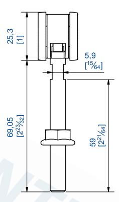
Monture sur roulement à billes avec bandage Nylon, avec axe INOX Capacité : 40 kg
