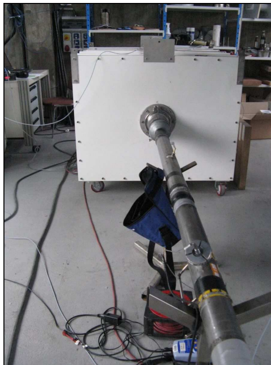
Figure 7 : Face aval du caisson avec débitmètre
