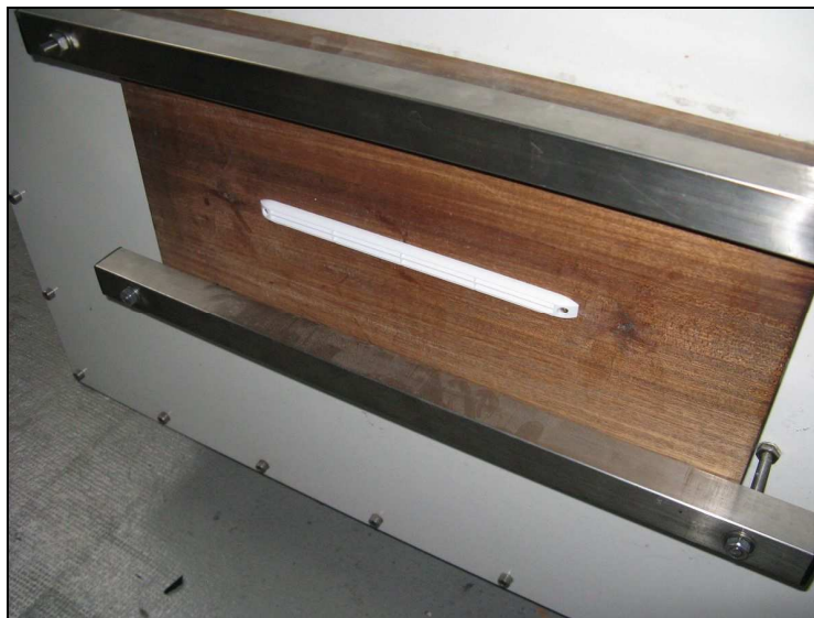
Figure 5 : Planche en bois exotique équipée du capuchon et de l'entrée d'air en essai
