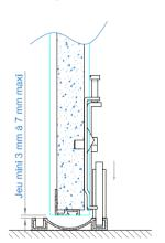
9- Ajuster les profils poignées au mur
