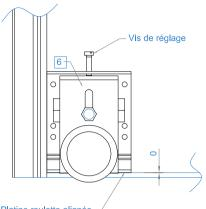
Platine roulette alignée avec le bas du panneau
