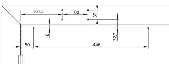
Schéma de fixation pour pose sur huisserie côté paumelles
