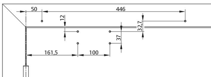
Schéma de fixation pour pose sur la porte côté paumelles
