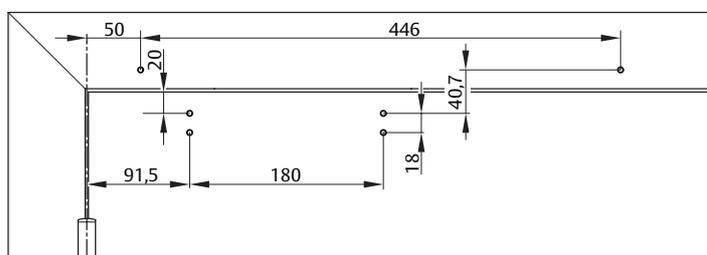
Schéma de fixation sur la porte côté paumelles avec plaque de montage
