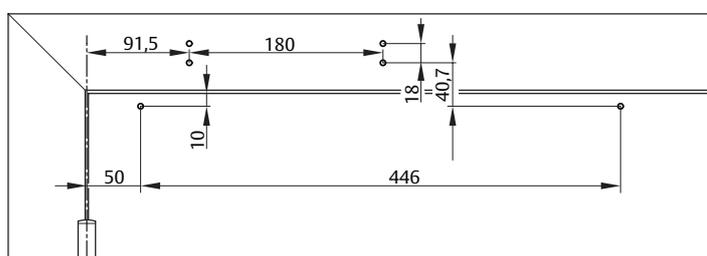
Schéma de fixation sur l' huisserie côté paumelles avec plaque de montage
