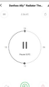
Lorsque la passerelle Danfoss Ally™ est réglée manuellement sur le niveau minimum, une bannière de notification s'affiche et l'icône centrale se met sur « Pause ». Pour quitter le mode Pause, cliquez sur l'icône centrale sur l'application Danfoss Ally™ et revenez à la consigne programmée ou manuelle.
