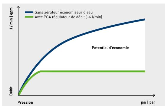
Les aérateurs PCA<sup>©</sup> sont équipés d'un régulateur de débit intégré. Le joint torique qui équilibre les pressions permet d'avoir un débit presque constant malgré des fluctuations de pression possibles. En plus d'économiser de l'eau, un débit constant permet aussi de répondre aux normes régissant de nombreux marchés actuels et à une répartition uniforme de l'eau depuis différents points de puisage.
