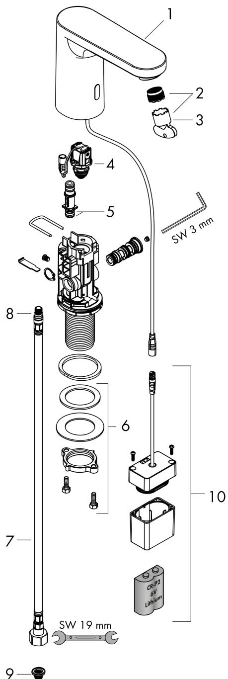
**Vernis Blend****Mitigeur de lavabo électronique en eau froide sur batterie**Finition: Chrome Numéro d'article: **71503000**
