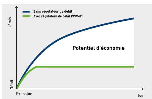
Avec le régulateur de débit PCW-01, un joint 1/2" avec régulateur de débit intégré, vous remplacez le joint habituel de votre flexible de douche. Le régulateur PCW-01 assume alors deux fonctions : l'étanchéité et la régulation du débit.
