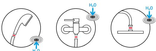
Dévisser le pommeau ou la pomme de douche. Retirer le joint en place et le remplacer par le PCW. Tourner la face avec le joint torique noir dans le sens du flux d'eau.
