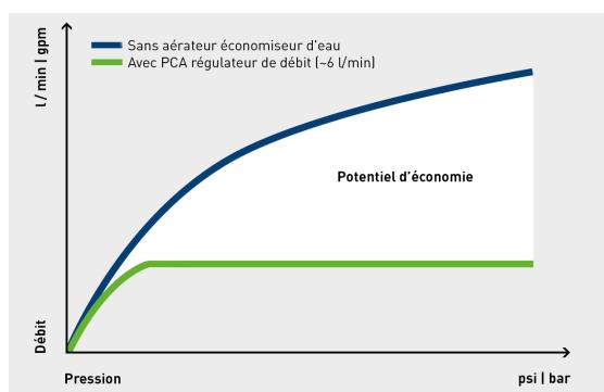
Les aérateurs PCA® sont équipés d'un régulateur de débit intégré. Le joint torique qui équilibre les pressions permet d'avoir un débit presque constant malgré des fluctuations de pression possibles. En plus d'économiser de l'eau, un débit constant permet aussi de répondre aux normes régissant de nombreux marchés actuels et à une répartition uniforme de l'eau depuis différents points de puisage.
