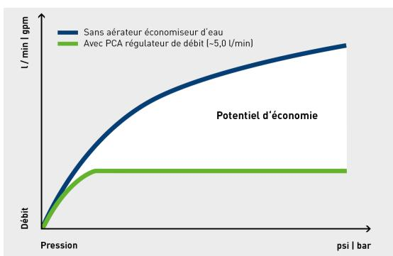
Les aérateurs PCA® sont équipés d'un régulateur de débit intégré. Le joint torique qui équilibre les pressions permet d'avoir un débit presque constant malgré des fluctuations de pression possibles.
