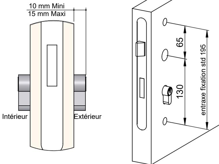
2- insérer le protecteur soit dans la plaque A ou soit sur le cylindre B
