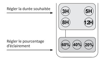
Une fois la durée d'éclairement écoulée, le projecteur passe automatiquement en mode détection
