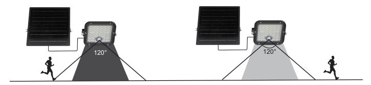
Le projecteur éclaire automatiquement à la nuit tombée. Il éclaire à 100% lorsqu'il détecte un mouvement Il passe à 5% d'éclairement après 30 secondes sans mouvement
