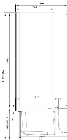
\* Cette cote correspond à la hauteur de la baignoire équipée d'un tablier. Réglage des pieds +/- 5 mm.
