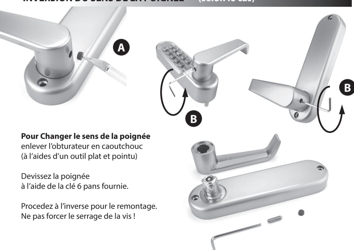
Pour Changer le sens de la poignée enlever l'obturateur en caoutchouc (à l'aide d'un outil plat et pointu)
