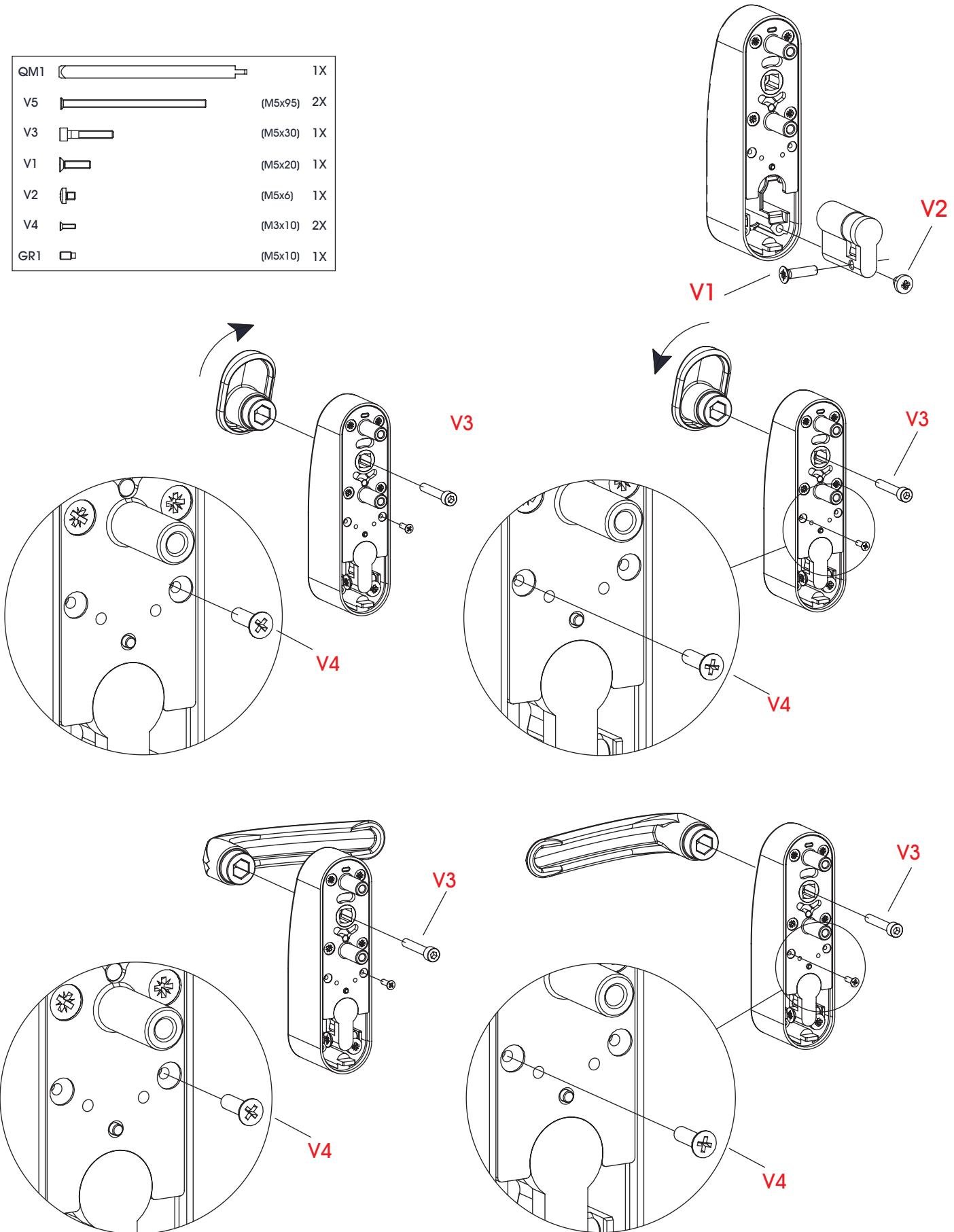
Sélection modalité standard et modalité "clé prisonnier"-Selection of standard mode and "key mechanism" mode
