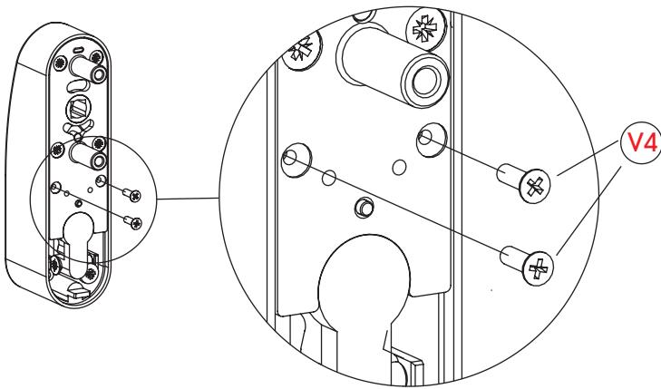
Si on installe les deux vis V4 fournies, on active la modalité « mécanisme à clé » qui permet l'ouverture de la porte la clé étant introduite et tournée en fin de course, en abaissant la poignée. Si la clé n'est pas engagée, la poignée revient sur la condition "neutre".
