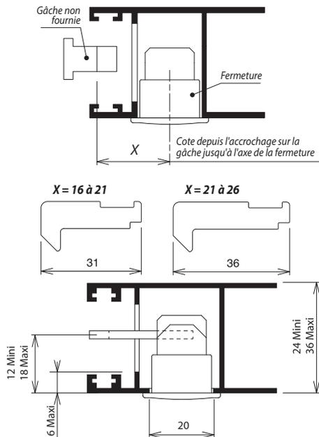
Cotes A, B, C, D et E : en fonction des profils et gâches utilisés
