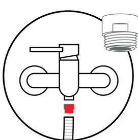
Vissez simplement le raccord de douche PCR comme un adaptateur, entre le robinet et le flexible de douche. Ne retirez pas le joint déjà présent dans le flexible de douche. Vissez-le plutôt au nouveau raccord.
