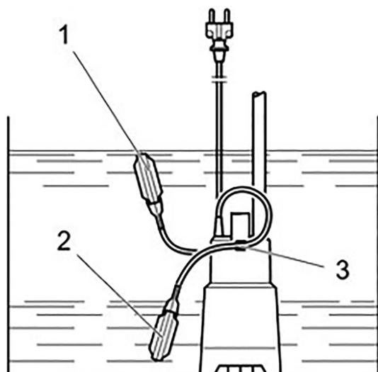
Une fois branchée sur le secteur, la pompe est enclenchée automatiquement par le positionnement des barrettes de réglage soit en mode manuel soit en mode automatique.
