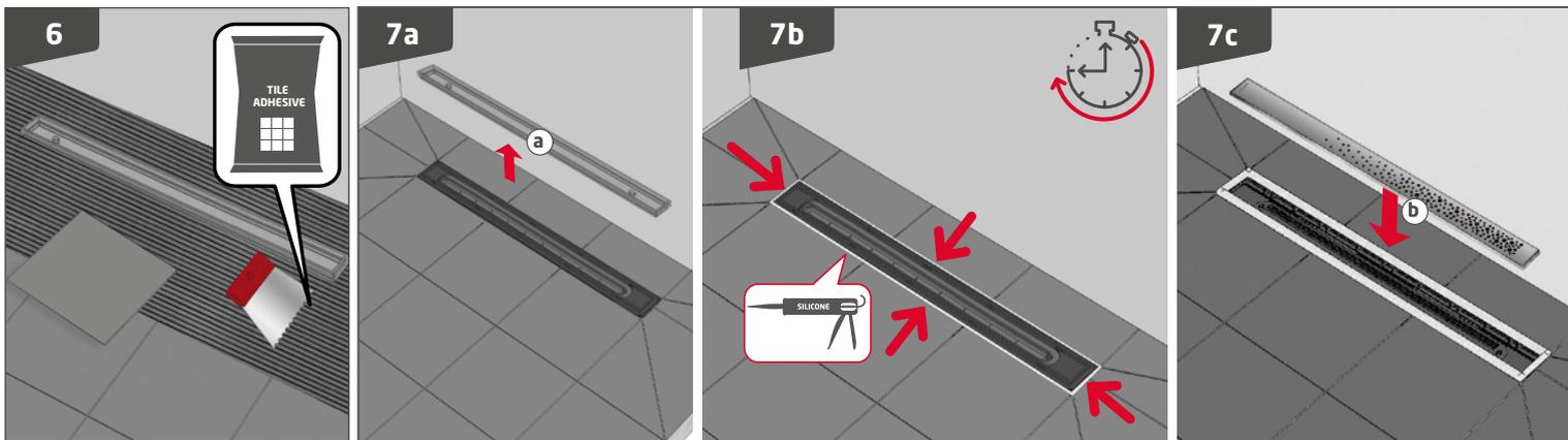
**FR 6- CARRELAGE:** Coller le carrelage au mortier colle et jointoyer le carrelage de préférence avec un joint epoxy.
