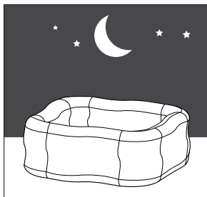
La baisse de température durant la nuit va réduire la pression d'air dans la structure du spa lui donnant un aspect moins gonflée.
