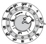
**EXEMPLE 2 :** Arroser 1 h par jour pendant 30 minutes, appuyez sur le bouton du milieu jusqu'à ce que la LED repose sur le point de Fréquence : 24H / Durée : 30 minutes, le premier arrosage démarre après 7 secondes.
