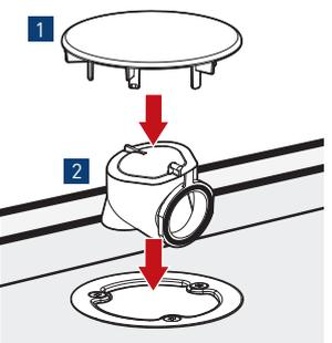
⚠ Couple de serrage recommandé 3Nm max. Le joint AUTOFIX\* va se compresser.
