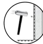
Enfoncer les clous dans les poteaux de soutien verticaux et non dans les planches horizontales
