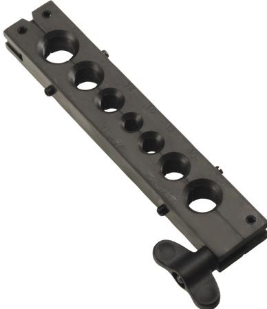
Les alésages de cette matrice sont chanfreinés à 90° sur une face pour former les collets coniques avec la toupie et à angle cassé sur l'autre face, pour obtenir les collets plats à l'aide des mandrins et après préformage à la toupie conique.
