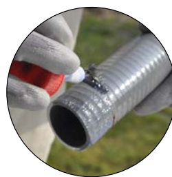
Coller l'extérieur du tube
