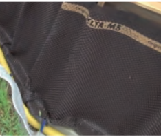
Alveolar protection in HDPE Protección alveolar en PEAD Protection alvéolaire en PEHD Alveolar Schutz in PEHD Protezione alveolare in PEAD Beschermdende HDPE-noppenfoli Proteção alveolar em PEAD
