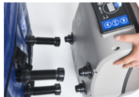
3) Svitare le tre raccordi del blocco motore..
