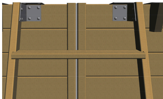
Figure 17 – fixation de l'escalier extérieur sur le bassin
