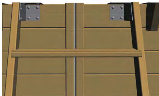
Figure 17 – fixation de l'escalier extérieur sur le bassin
