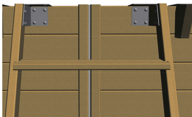
Figure 18 – Fixation de l'escalier extérieur sur le bassin
