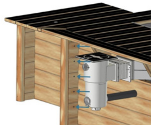
Figure 64 – Fixation du coffre sur le bassin
