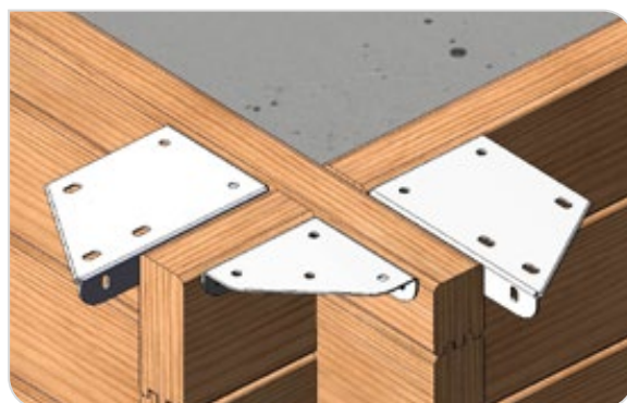
Figure 24 – Les ferrures dans les angles
