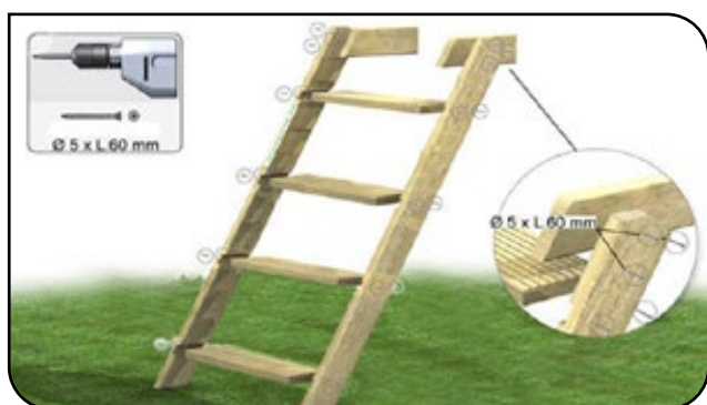
Figure 57 – Assemblage de l'échelle en bois
