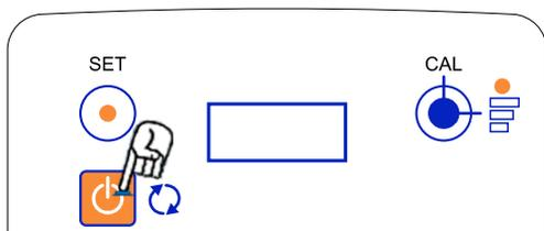
Lorsque l'appareil est en fonctionnement, un appui bref sur la touche « ON/OFF » arrête l'appareil.
