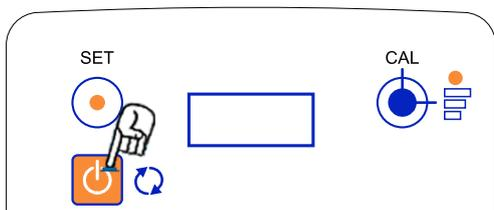
Lorsque l'appareil est éteint (afficheur OFF), maintenir appuyée la touche ON/OFF pendant au moins 3 secondes pour amorcer la pompe.
