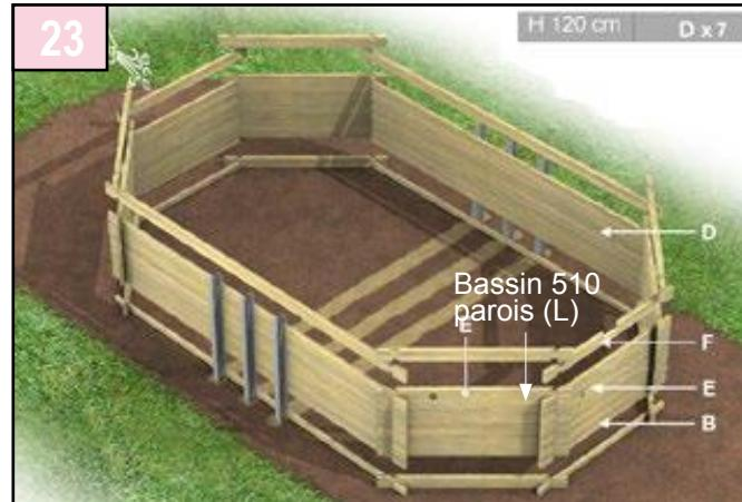
Emboîtez l'ensemble des parois restantes (B) pour les petits côtés avec les parois (D) des grands côtés en prenant soin du positionnement de la paroi percés (E) destinée au refoulement, de la paroi usinée (F) (pour le positionnement des ces lames reportez-vous à l'éclaté situé en fin de notice). La paroi de refoulement (E) doit être positionnée au-dessus de 4 parois (B) + 1 paroi (A). La paroi (F) étant située sur le même côté au dernier rang de cette étape de montage.
