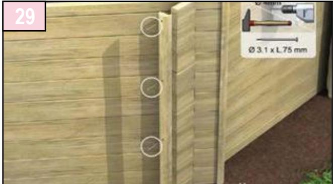
Fixez à chaque extrémité de paroi, à l'aide de 4 pointes inox (3.1x75mm) réparties équitablement, les profils de recouvrement (type H) que vous aurez au préalable prépercés dans l'axe
