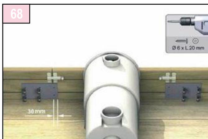
Observer l'illustration ci-dessus. Fixer les plaques (identiques aux plaques de jonction) à l'aide vis (sachet M).
