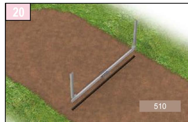
Une fois les berceaux assemblés présentez-les dans les saignées et calez-les en utilisant si besoin du sable mouillé compacté. Lors de cette opération, veillez à contrôler niveau, aplomb, alignement et parallélisme. Comblez les saignées en utilisant un complément de sable mouillé damé. Important ! Veillez à respecter la bonne profondeur d'enfoncissement des berceaux correspondant à votre bassin.
