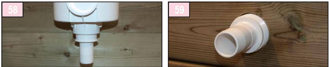
Mettre 3 tours de téflon (non fourni) sur le filetage du raccord cannellé avant de le visser sur le corps du skimmer. Emboîter le tuyau de retour du filtre sur le raccord cannellé de la buse de refoulement et le fixer au skimmer. Emboîter le tuyau d'aspiration de la pompe sur cannelé du skimmer et le fixer au moyen d'un collier de serrage.
