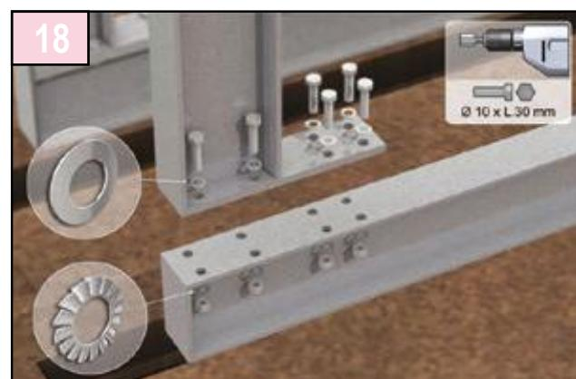
Approchez du bord des saignées les éléments qui composent les berceaux et assemblez-les (à l'aide du kit platine berceaux).
