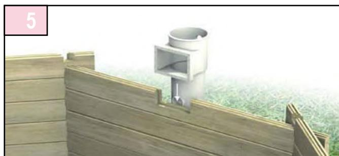
A ce stade, il est nécessaire d'engager le skimmer ou le bloc de filtration dans la paroi usinée (type D).
