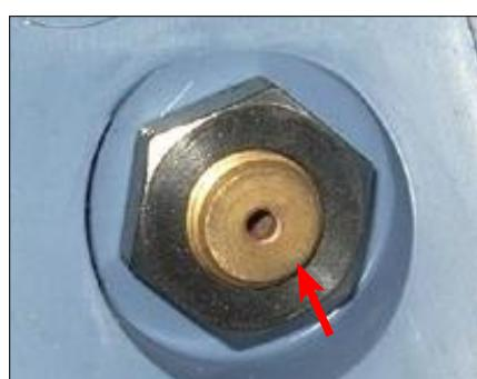
Par le dessous du couvercle, visser l'écrou laiton à la main puis serrer modérément à la clé à pipe de 22 afin de ne pas détériorer le joint.
