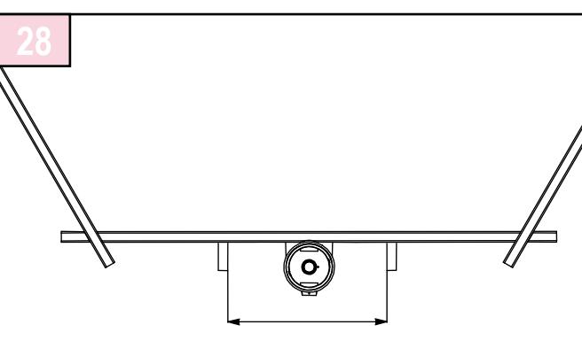
Sur la paroi recevant le skimmer, les consoles au nombre de 2 sont positionnées à équidistance de part et d'autre de l'axe du skimmer. La cote entre les deux consoles varie en fonction des modèles, se reporter au tableau ci-dessus
