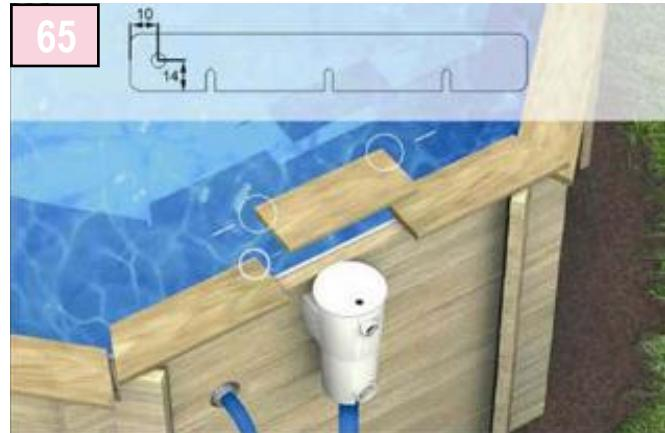
Avant de fixer les 3 éléments de la margelle skimmer, percer au diamètre 6mm, l'élément central ainsi que les éléments d'extrémités aux cotes indiquées. Veiller à effectuer un perçage précis et bien en ligne. Les perçages effectués insérer les pivots (sachet réf 27511070), puis repositionner les éléments.
