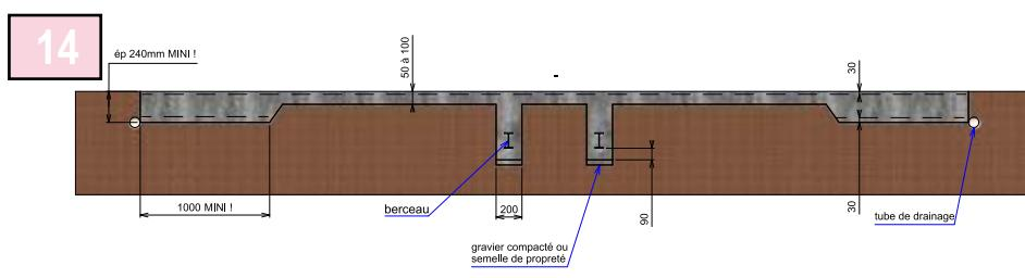
Schéma de principe de la dalle
