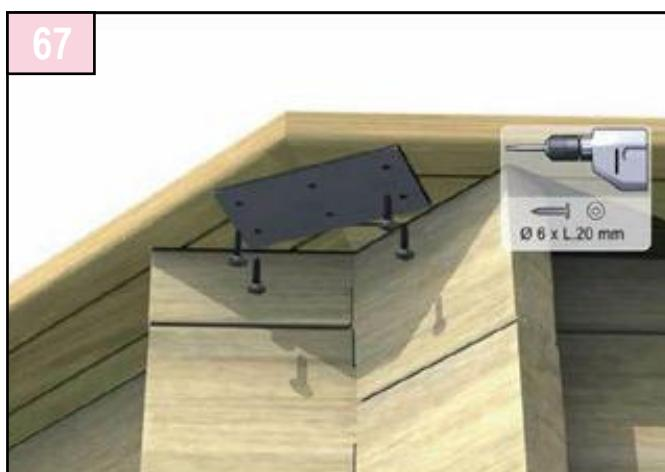
Il vous reste à fixer aux 8 angles de la margelle, les pièces de jonction (sachet 27511671) comme illustré ci-dessus) en veillant à bien positionner la pièce en butée contre l'angle formé par les débords de lames.
