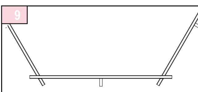
Les consoles sont au nombre de 1 par pan (sauf pan recevant le skimmer). Positionnez 1 console au centre de la lame.
