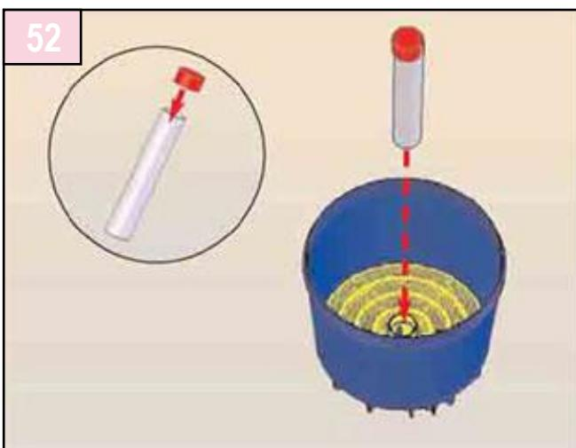
Coiffez le tube plongeur avec le bouchon de protection et l'insérer dans le trou au milieu du plancher crépiné. Verser progressivement et doucement la charge de sable dans le filtre et l'étaler à la main.
