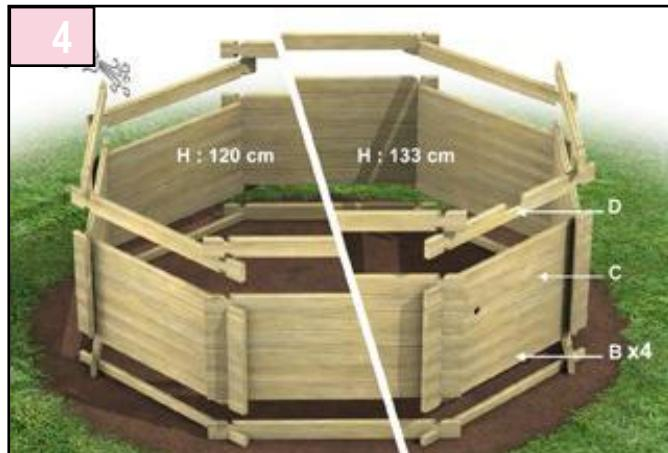
Emboîtez l'ensemble des parois restantes (type B) en prenant soin du positionnement de la paroi de refoulement (type C) et de la paroi usinée (type D). La paroi de refoulement (type C) doit être positionnée au-dessus de 4(type B) + 1 paroi (type A) dans le cas d'un skimmer et dans le cas d'une filtration autonome. La paroi de refoulement doit se situer juste en dessous des lames usinées. La paroi de type D est située sur le même côté au dernier rang de cette étape de montage.
