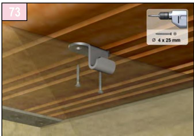
L'échelle bois est équipée de deux fermetures à levier permettant un verrouillage efficace de celle-ci. Les parties levier sont à fixer sur les supports d'échelle et les crochets sous la margelle (vous trouverez ces pièces dans le sachet K). Il est nécessaire d'étudier le fonctionnement de ces 2 pièces ensemble pour en comprendre le fonctionnement et évaluer la course nécessaire à un verrouillage efficace de l'échelle une fois en place.
