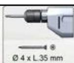
Fixez le rail à l'aide d'une vis à 2 cm de chaque extrémité. Puis complétez la fixation par environ une vis tous les 20 cm. Utiliser les vis Ø4 x 35 (sachet D).
