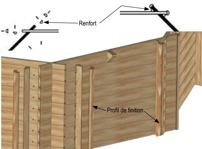
**Pour fixer le renfort par l'extérieur :** Positionner les vis à 100mm de l'angle. Mettre une vis par lame
