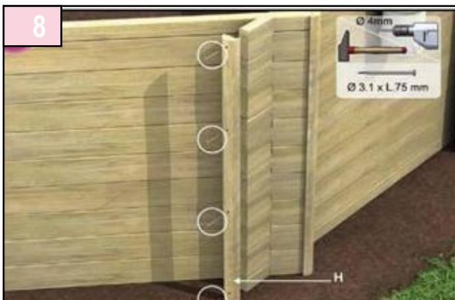
Fixez à chaque extrémité de paroi, à l'aide de 4 pointes inox (3.1x75mm) réparties équitablement, les profils de recouvrement (type H) que vous aurez au préalable prépercés dans l'axe.
