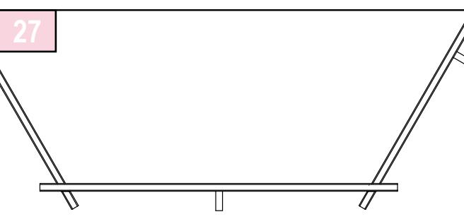
Les consoles sont au nombre de 1 par petit pan (sauf pan recevant le skimmer). Positionnez 1 console au centre de la lame.
