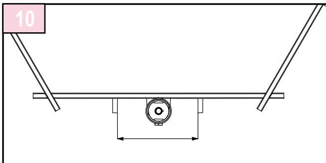
Sur la paroi recevant le skimmer, les consoles au nombre de 2 sont positionnées à 75 cm l'une de l'autre, de part et d'autre de l'axe du skimmer.
