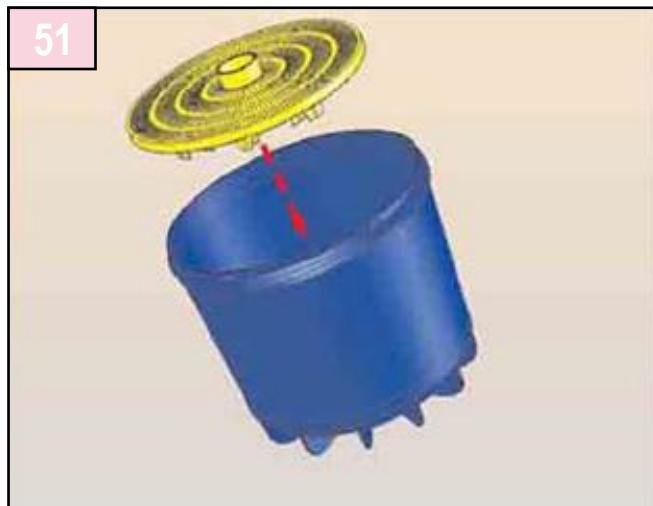
Déposez le plancher crépiné au fond de la cuve. Vérifiez qu'il repose bien à plat.
