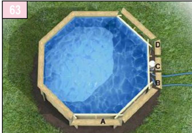
Après avoir observé sur le dessin la répartition des différentes planches constituant la margelle, disposer les sur les consoles. Contrôler le positionnement des éléments sur tout le pourtour du bassin. Au besoin, ajuster et veiller à conserver ce positionnement jusqu'au vissage.
