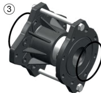
③ Remplacer et graisser les joint n°2 (VJEC--\*) d'étanchéité avec les embases a coller (graisse silicone pour contact alimentaire)
