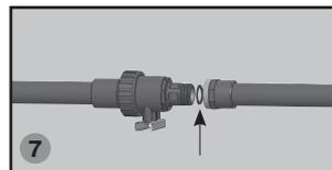
Mettre le joint plat dans le manchon taraudé.
