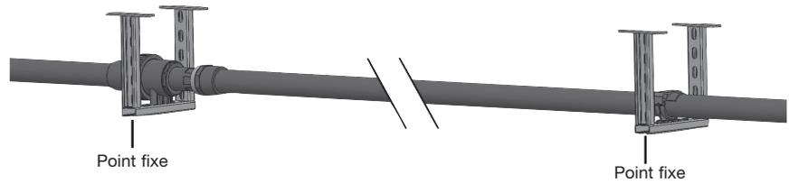
Son montage peut être **vertical ou horizontal** et ne nécessite pas de sens de pose particulier par rapport au flux. Les compensateurs ne devront pas être positionnés face à face sans point fixe intermédiaire. Se reporter à la notice de pose livrée dans le colis du HCOMP.
