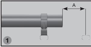
Réaliser un point d'ancrage rigide à la distance "A" de l'extrémité du tube de départ.
