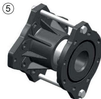
⑤ Insérer le piston dans l'axe de manière à ne pas pincer les joints. Ré-assemblez le compensateur et remontez les vis n°9 (VISEP12/195) avec un couple de serrage de 40Nm
