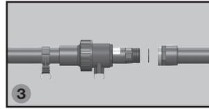
Présenter la longueur de tube à compenser. Souder le manchon taraudé sur le tube puis raccorder l'ensemble à la partie mobile à l'aide du joint plat.
