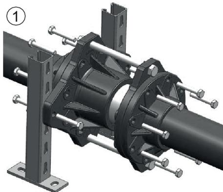
① Démontez les vis n°4 (VIS10/60) et les vis de fixations aux ancrages
