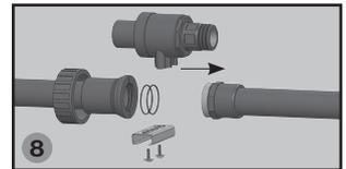
8 Procéder en sens inverse pour le démontage, mettre le piston dans le corps et emboîter les éléments dans le collet.
