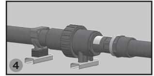
Créer le point fixe sur un support rigide à l'autre extrémité de la longueur et retirer le témoin de pose.
