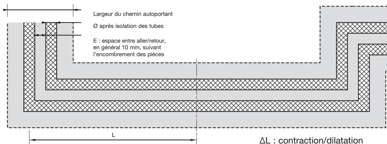
$$\text{Largeur du chemin autoportant} \geq (2\text{Ø} + E) + 2\Delta L \text{ maxi}$$
