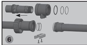
6 Retirer les joints à l'aide d'un tournevis plat en prenant soin de ne pas détériorer les portées.
