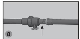
R ressortir le piston du compensateur et le visser sur le manchon taraudé en prenant appui sur le 6 pans du piston. Attention, ne pas utiliser de clef à griffes qui pourrait rayer le piston.
