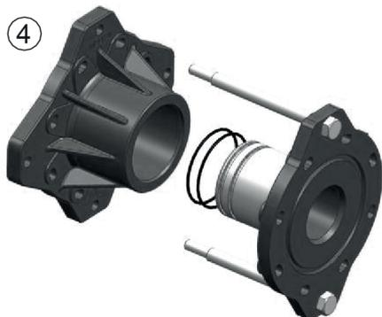
④ Démontez les vis n°9 (VISEP12/195), remplacez et graissez les joints n°8 (VJECARP--\*) d'étanchéité avec le corps (graisse silicone pour contact alimentaire)
