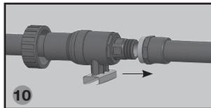
10 Sortir complètement le piston et le visser sur le manchon taraudé avec le joint plat neuf.
