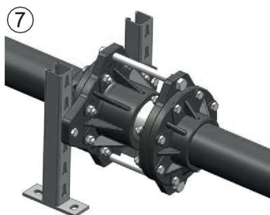
⑦ Finir d'assembler les embases au compensateur avec les vis n°4 (VIS10/60) avec un couple de serrage de 40Nm
