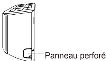
3. Si la tuyauterie de raccordement est déjà encastrée dans le mur, passer directement à l'étape **Raccorder le tuyau de vidange**. S'il n'y a pas de tuyauterie intégrée, raccorder la tuyauterie de réfrigérant de l'unité intérieure à la tuyauterie de raccordement qui permettra de relier les unités intérieure et extérieure. Se reporter à **Raccord de tuyauterie de réfrigérant** dans ce manuel pour plus des instructions détaillées.
