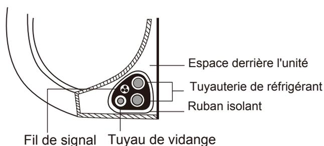
**LE TUYAU DE VIDANGE DOIT ÊTRE SUR LE BAS**
