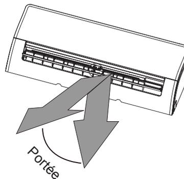
REMARQUE : Ne pas déplacer le déflecteur à la main. Cela désynchronise le volet. Si cela se produit, éteindre l'appareil et le débrancher pendant quelques secondes, puis le redémarrer. Cela réinitialise le volet.
