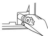
Pour éviter les fuites indésirables, boucher le trou de vidange inutilisé avec le bouchon en caoutchouc fourni.
