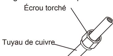
4. Retirer le ruban de PVC des extrémités du tuyau lorsque le travail à la torche est prêt à être exécuté.
