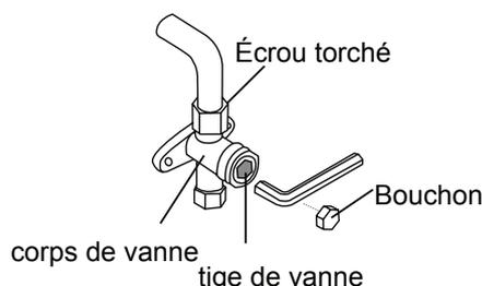
12. Avec un clé hexagonale, ouvrir complètement les vannes basse et haute pressions.
