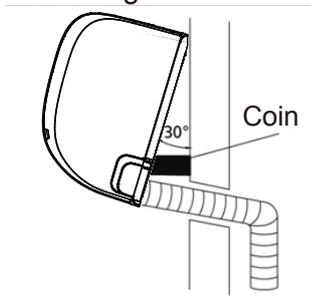
3. Raccorder le tuyau de vidange et le tuyau de réfrigérant (se reporter à la section Raccordement de la tuyauterie de réfrigérant de ce manuel pour les instructions).
