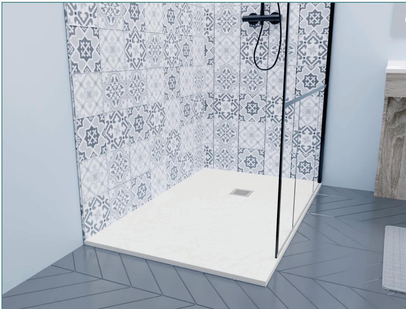
Receveur de douche extraplat en résine **alégée** gelcoatée (mélange de marbre de synthèse et de microsphères de polymère garantissant **un poids d'environ 40% inférieur à un receveur béton gelcoaté classique**), d'épaisseur 25 à 35 mm (tolérance de +/-2 mm) avec une surface antiglisse (catégorie 3) finition ardoise. Grille inox de 131 x 131 mm.
