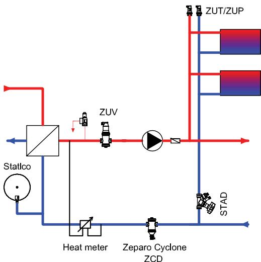
Le séparateur de boues Zeparo Cyclone sera installé en ligne sur le retour, en amont de l'équipement à protéger ou en amont de la source d'énergie calorifique/frigorifique. Aucune distance minimale n'est requise entre le Zeparo Cyclone et les coudes et tés sur la tuyauterie.
