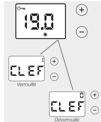
Cette fonction permet de bloquer l'accès aux réglages de l'appareil afin d'empêcher toute modification intempestive. La touche Marche / Arrêt chauffage demeure active, même quand le verrouillage parental est activé.
