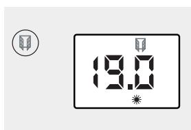
**i** Cette fonction arrête automatiquement le chauffage en cas de détection d'une chute brutale de la température dans la pièce (Ex : une fenêtre ou une porte ouverte).
