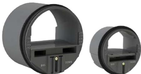
Le régulateur de débits réglables **RDR BP** peut être réglé sur chantier au débit souhaité. Les graduations sur les côtés de l'ouverture indiquent les réglages.
