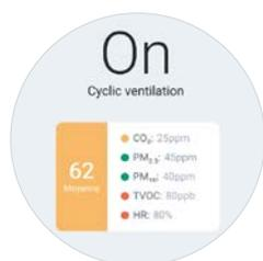
Configuration du mode de ventilation cyclique pour programmer des créneaux du temps de ventilation.
